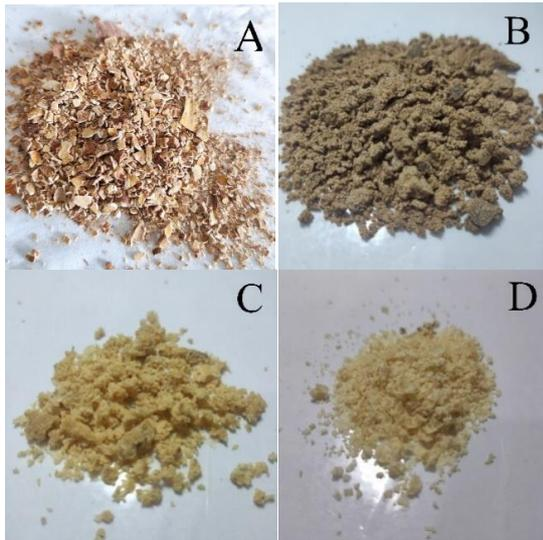
**Gambar 1.** Sampel (A) Bahan Baku dan setelah Proses (B) Alkalisasi, (C) *Bleaching*, (D) Hidrolisis
