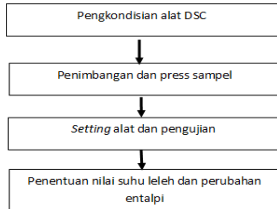
Gambar 3. Diagram Alir Pengujian DSC
