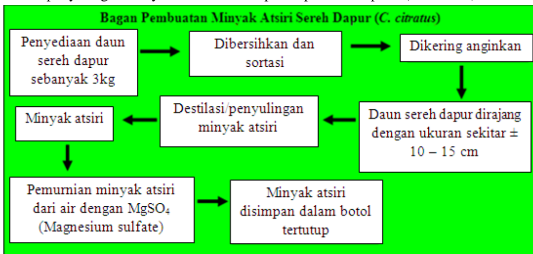
Gambar 1. Bagan Pembuatan Minyak Atsiri Sereh Dapur (Dokumentasi pribadi, 2012)
