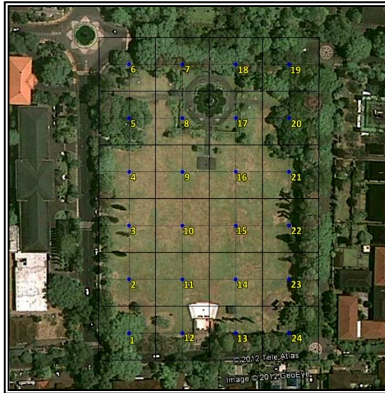
Gambar 2. Metode grid untuk pengambilan data suhu udara dan kelembaban
