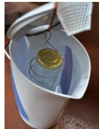
**Gambar 4.** Prototipe Cerek Elektrik dengan *Flash Heat Treatment System*.<sup>[16]</sup>
