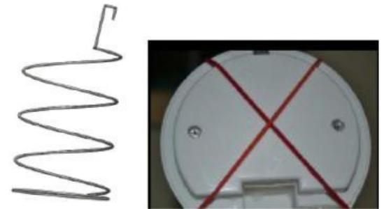
**Gambar 3.** Kerangka Kawat (Kiri) dan Modifikasi Tutup Cerek Listrik dengan Menggunakan Karet Gelang sebagai Penahan Kawat (Kanan).<sup>[16]</sup>
