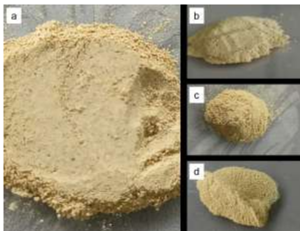
Gambar 1. Hasil sintesis \text{SnO}_2 (a) tanpa aditif selulosa (b) aditif 3:1 (c) aditif 2:1 (d) aditif 1:1.
