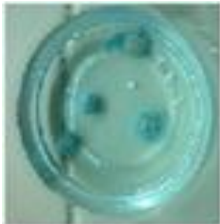
Gambar 6. Pengujian perendaman pupuk granul NPK 16-16-16 komersil
