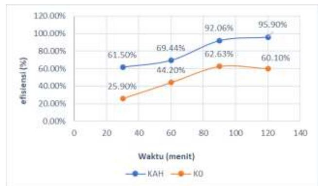
Gambar 1 Kurva Banyaknya Adsorbat yang Teradsorpsi Biosorben Pada Variasi Waktu Kontak
