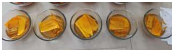
Gambar 2 Serat Alam yang Diwarnai Kemudian Difiksasi dalam Larutan Tawas (Dokumentasi pribadi, 2020)
