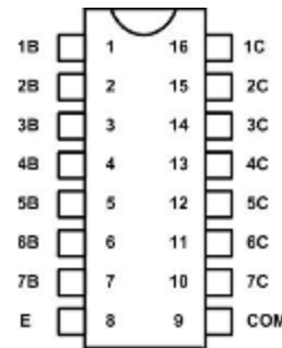
Gambar 2.6 Struktur pin out IC ULN 2003 (Kurniawan, 2009)
