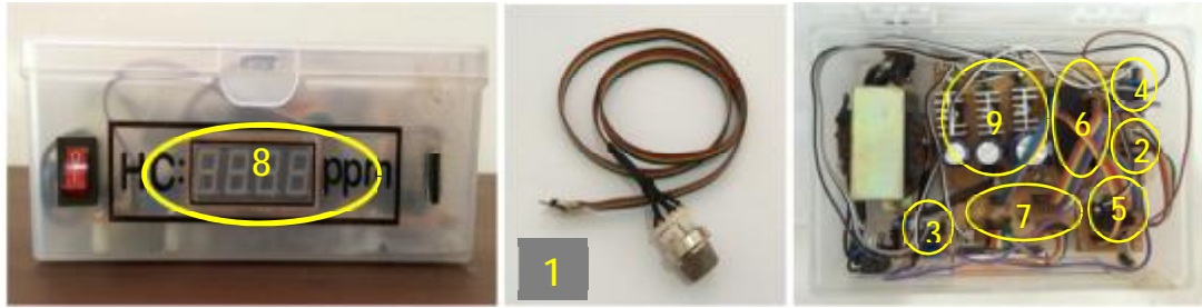
Gambar 4.1 Alat ukur gas hidrokarbon dengan menggunakan sensor MQ-4 berbasis mikrokontroler AT89S52.
