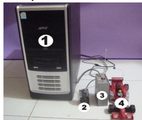
Gambar 2. Sistem pengendali robot dengan menggunakan isyarat posisi pupil mata. (1) PC, (2) Webcam , (3) Remote control , (4) Prototipe robot.
