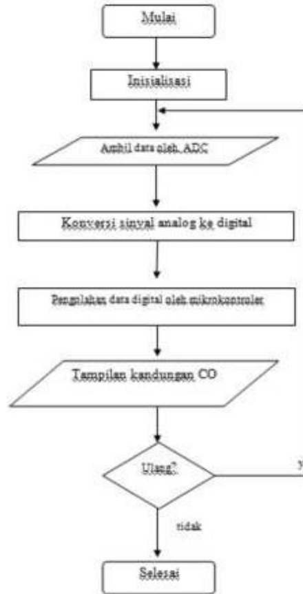
Gambar 3.2. Diagram alir program alat ukur kandungan gas CO pada gas buang kendaraan berbasis Mikrokontroler AT89S52.
