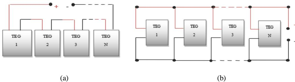
Gambar 2. Rangkaian (a) seri dan (b) paralel.
