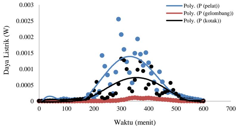
**Gambar 3.** Perbandingan daya listrik pada seng pelat, seng gelombang, dan seng kotak untuk konfigurasi seri.
