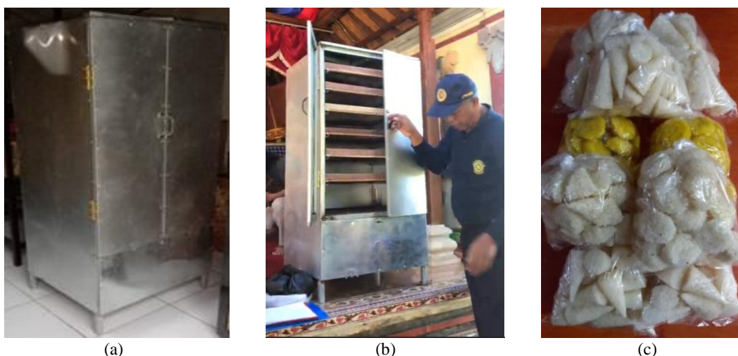
Gambar 3. Alat pengering untuk tumpeng beras: (a) tampilan luar alat, (b) demonstrasi penggunaan alat, dan (c) beberapa contoh tumpeng beras kering
