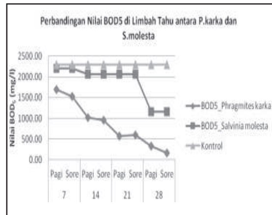
Gambar 2. Grafik Perbandingan Nilai BOD 5 Limbah Tahu antara P. Karka dan S. molest
