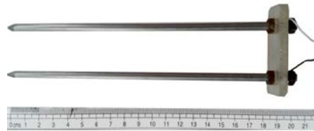
Gambar 5. Sensor kadar air tanah resistif
