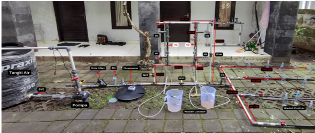
Gambar 2. Sistem fertigasi injektor venturi ganda posisi vertikal.
