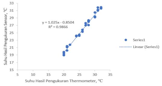
Gambar 3. Hubungan dan Suhu dari Kedua Hasil Pengukuran
