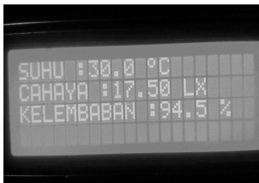
Gambar 8. Tampilan suhu, kelembaban dan intensitas cahaya pada LCD 4x20
