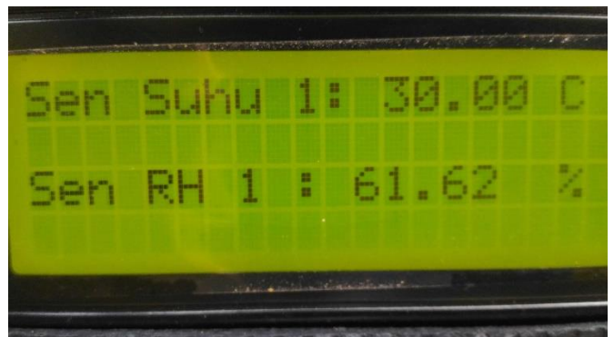
Gambar 11. Tampilan Suhu dan Kadar air kompos pada LCD
