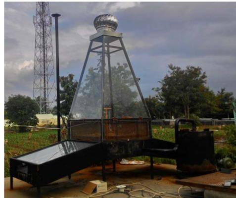
**Gambar 1.** Pengering tipe bak dengan sumber panas dari tungku sekam kopi dan kolektor surya
