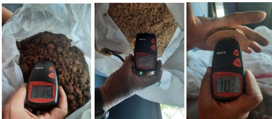
Gambar 1. Pengukuran Kadar Air Awal Bahan Baku
