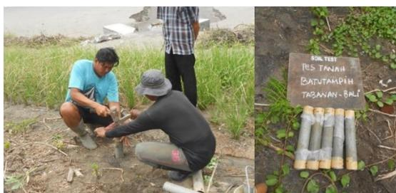
Gambar 17. Pengambilan sampel tanah untuk pengujian *Direct Shear Test*
