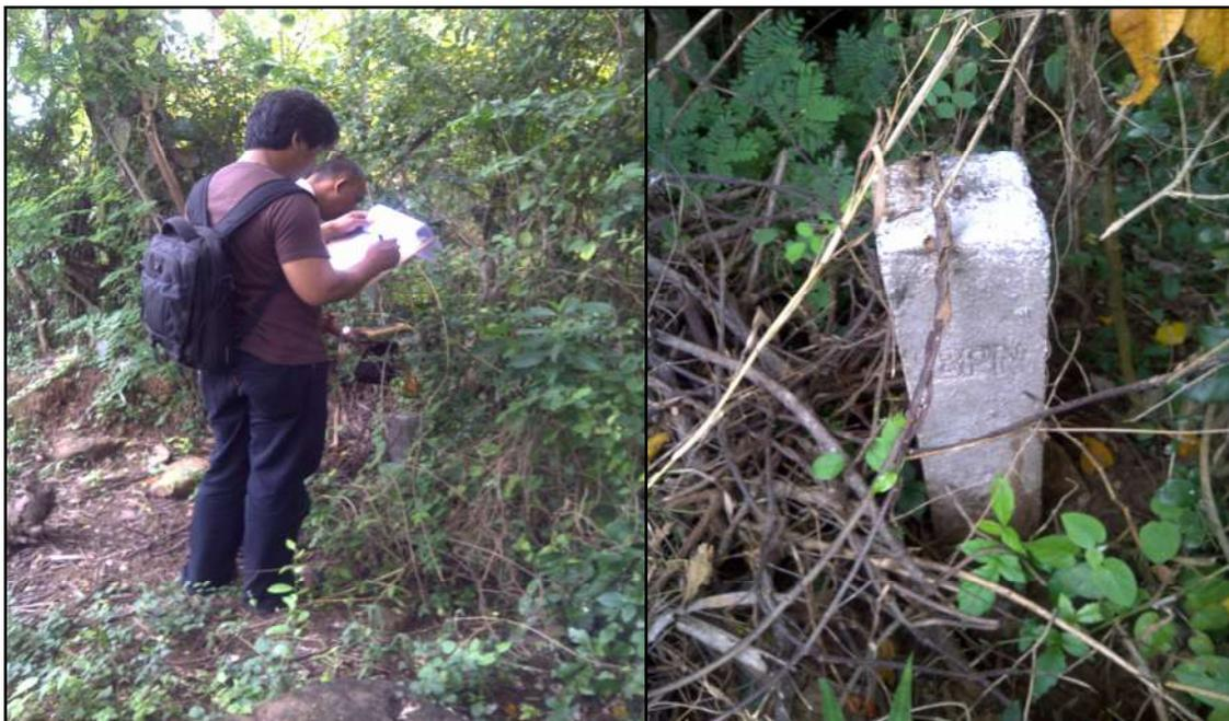
**Gambar 1.** Pengukuran dengan GPS dan Titik Persil milik BPN
