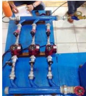
Gambar 5. Sistem perpipaan pompa paralel
